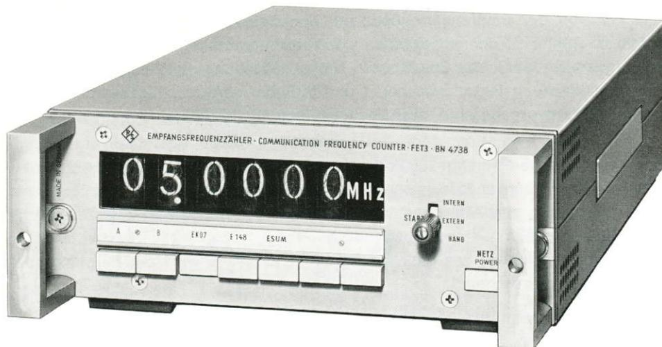
Elektronischer Zähler zum frequenzgenauen Einstellen von Funkempfängern und Peilern - mit Digitalausgang zur Fernübertragung
